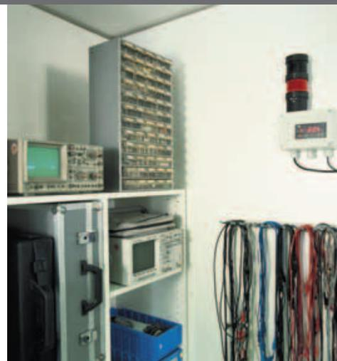
Las dos salidas relé del testo 54 permiten dos alarmas descentralizadas cuando se exceden los valores límite, p.ej. con la ayuda de la columna de alarma
