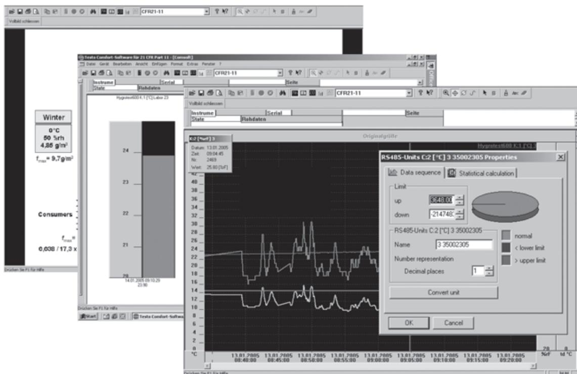
Ademas del almacenamiento electrónico, la impresión de informes con los datos de medición todavía es importante en el control de calidad diario. El ComSoft permite la creación de protocolos e informes compatibles 21 CFR 11.
