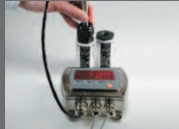
Reajuste con soluciones salinas de calibración
