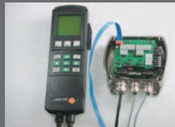
Inspección con el instrumento portátil testo 400/650
