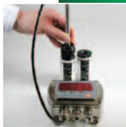
Las soluciones salinas de uso continuado se utilizan para realizar económicas calibraciones en dos puntos in situ
