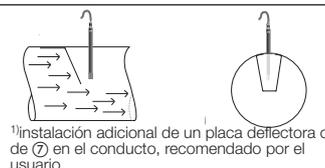
¡Instalación de la sonda en vertical desde arriba!
